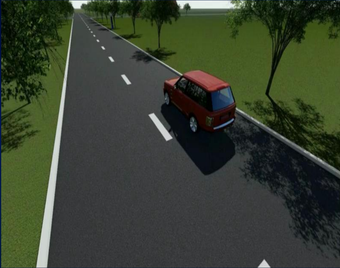
A区雷达感应来车，向B区行人预警左侧来车
